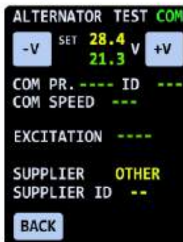
Figura 8. Ventana de diagnóstico del alternador del tipo «COM» de 24V
