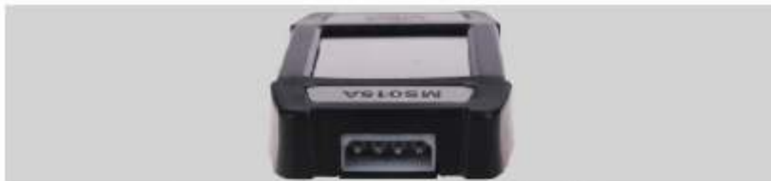
Figura 2. Conector para conectar el cable de diagnóstico.
